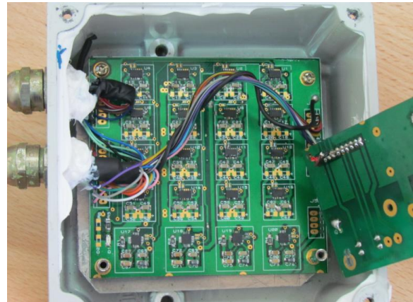
شکل (۷) نمونه ساخته شده برد حسگرهای شتابسنج و ژيروسکوپ.
