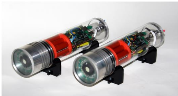
شکل (۱) دو مودم (فرستنده-گیرنده اپتیکی) Aquaoptical II [۸].
