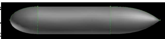
شکل (۸) هندسه شناور زیرسطحی Myring
