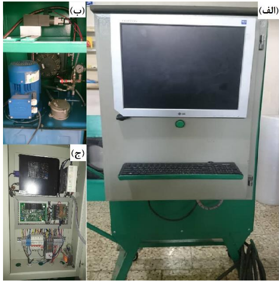
شکل (۳) (الف) دستگاه نوسان ساز، (ب) واحد هیدرولیکی، (ج) واحد الکترونیکی و کامپیوتری.
