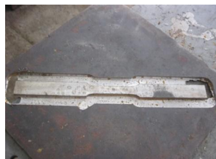
شکل (۴) نمونه‌ای از برش نمونه‌ها بر اساس استاندارد ASTM.
