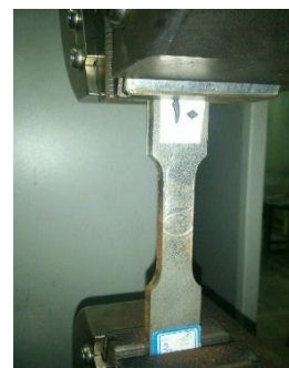
شکل (۵) نمونه در حال اعمال تست کشش توسط دستگاه یونیورسال.
