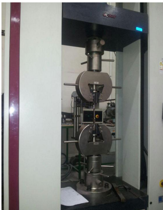
شکل (۲) تصویری از دستگاه تست کشش یونیورسال DT&T.
