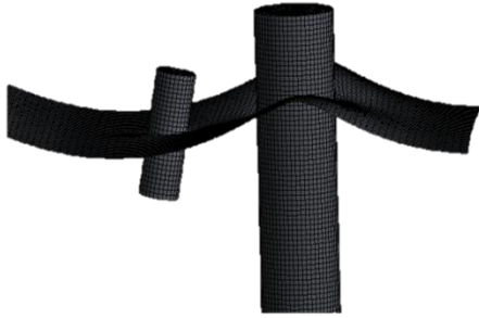
شکل (۷) نمایش شماتیک استوانه ثابت و شناور در امواج استوکس.
