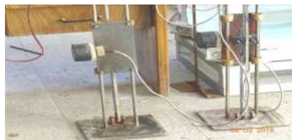
شکل (۱۲) حسگرهای آکوستیکی ساخت شرکت B&K با فرکانس مرکزی ۵۰ کیلوهرتز.
