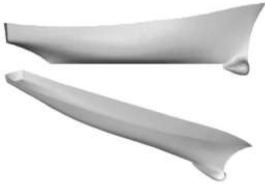
شکل (۲) هندسه بدنه کشتی INSEANC2340 برای اعتبارسنجی روش حل عددی.
