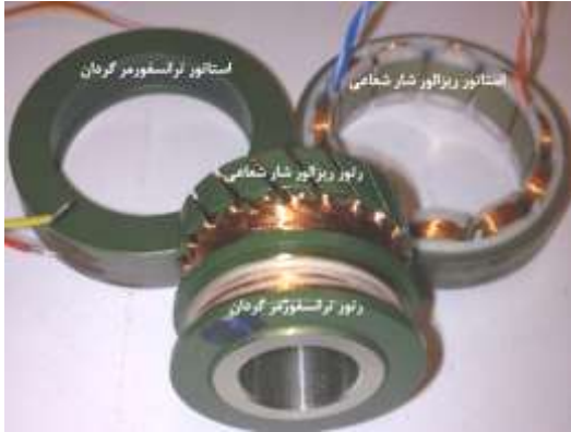
شکل (۱) ریزالور بدون جاروبک دارای ترانسفورماتور گردان.
