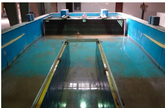
شکل (۲) فلوم آزمایشگاهی مورد استفاده به همراه مولد موج.
