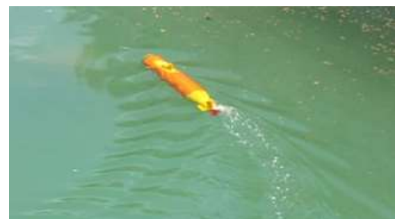
شکل (۶) تصویر AUV در حرکت سطحی.
